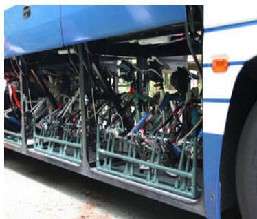
独自に開発した専用積載キットを使用し運搬
