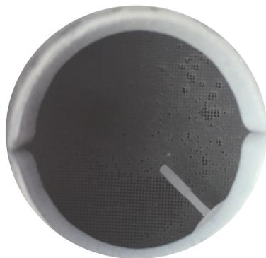
アイディー・クリーナーは燃料触媒液を添加しているため、酸化触媒および DPF に付着した有機化合物を燃焼させます。通常の煤は 300～400℃で燃え始めますが、燃料触媒液の効果で 200℃から煤が燃え始めます。また、アイディー・クリーナーは燃えやすい煤をデポジットの表面に付着させ、さらに燃焼温度を上昇させる溶液を添加したことで触媒周辺の温度を上昇させます。こうしたことから付着したデポジットは燃えて低減します。
